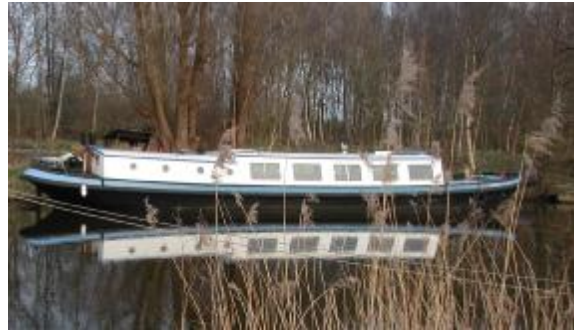
Figuur 2: Woonark met stalen casco
